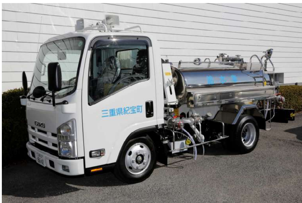
写真 4-29 給水タンク車
