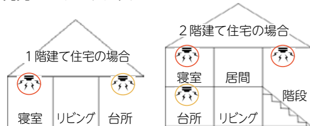
○設置義務(煙式) ○設置推奨(熱式)
