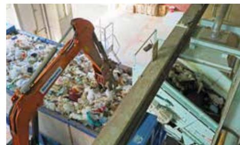
6. ベルトコンベアで運ばれてきたごみをコンテナに積みます
