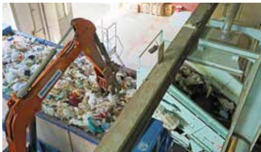
6. ベルトコンベアで運ばれてきたごみをコンテナに積みます
