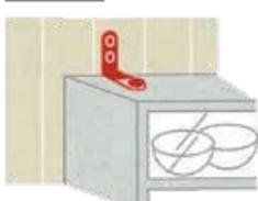
L字型金具を使って壁などに固定
