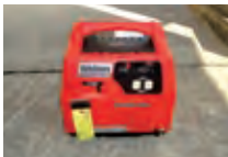
LPガス発電機
