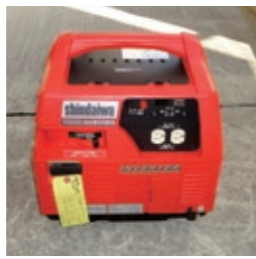
LPガス発電機
