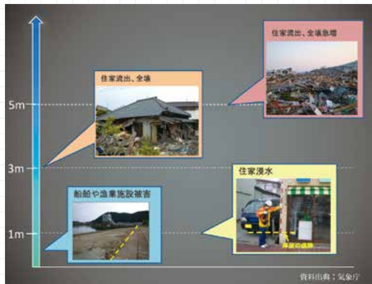
津波の高さと被害（東日本大震災の事例より）
